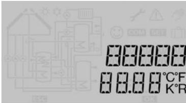
El indicador de canal consta de dos líneas. La línea superior es una línea alfanumérica de 16 segmentos que indica principalmente el nombre de los canales y los distintos submenús. La línea inferior de 16 segmentos muestra valores.
