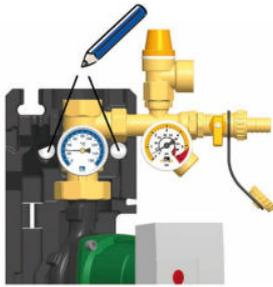
Retire la parte frontal del aislamiento y fije la estación solar a la pared con los tornillos incluidos en el hardware de montaje.
