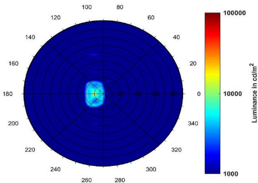
Des mesures supplémentaires confirment la faible réflectance du panneau “anti-éblouissement”, quel que soit l’angle d’incidence appliqué, en comparaison avec un “panneau normal” dont le verre a seulement un traitement anti-reflet de base. Voir le second extrait de rapport de test ci-dessous:
