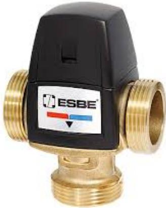
Elle est installée en sortie des panneaux solaires en amont de la pompe à chaleur. Elle sert à limiter la température en entrée de l'évaporateur de la pompe à chaleur lorsque la température en sortie du champ solaire dépasse sa température de consigne en mélangeant avec du fluide provenant de l'évaporateur comme vous pouvez le voir sur le schéma présent dans le chapitre [Principe de fonctionnement d'un système solarothermique et définition des termes](#) [5].
